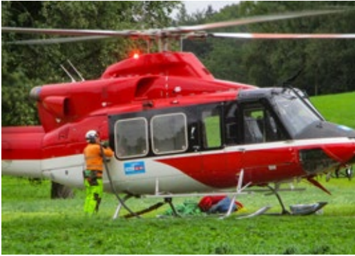
Abb. 1 Der Helikopter Bell 412 mit nach unten und außen gewölbtem Fenster auf Höhe des Piloten. Alle Aufnahmen MARTIN SALM.
